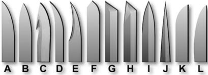
A) Straight; B) Drop Point; C) Gut Hook; D) Trailing Point; E) Clip Point; F) Sprey Point; G) Tanto/Chisel; H) Americanized Tanto; I) Spear Point; J) Needle Point; K) Sheepsfoot; L) Wharncliffe;
